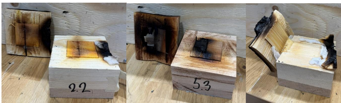
Joonis 18 Katsekehade purunemisviisid: vasakul liimist, keskel liimi-puidu koosmõjul, paremal puidust
