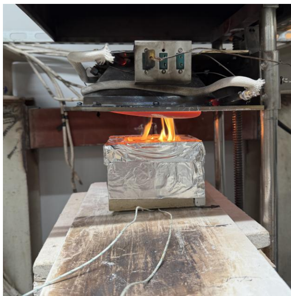
Joonis 13 Tootja A katsekeha koonuskuumuti all
