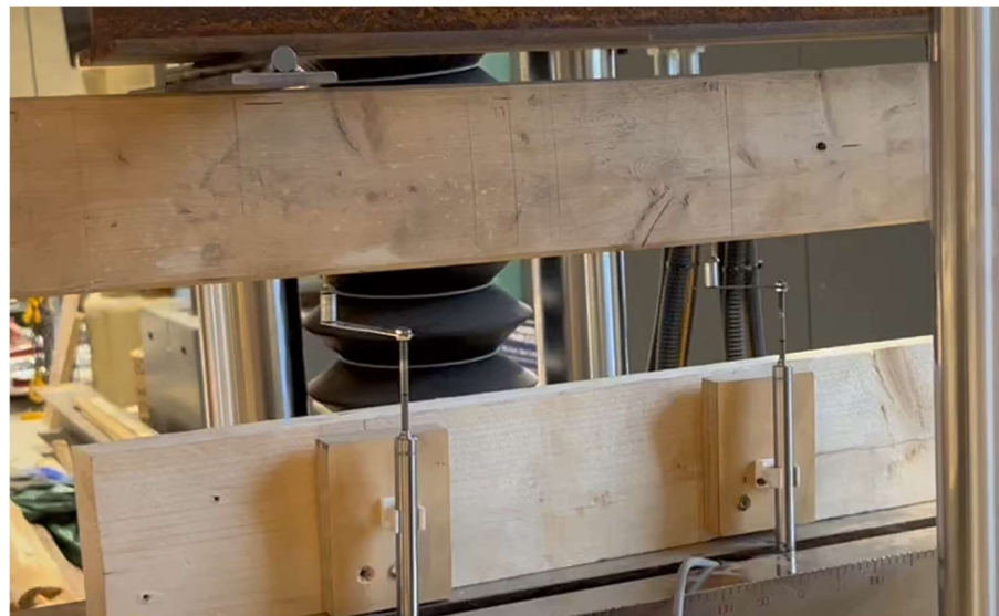
Joonis 3.6 Siirdekellade kinnitused ja paiknemise asukohad
