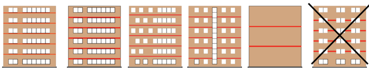
Joonis 11. Puitfassaadi läbivate tuletõkestite asukohad.
