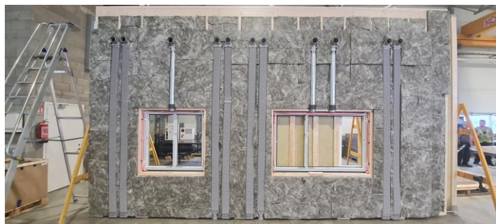
Joonis 17. Ventilatsioonitorustik fassaadielemendis, akna kohal paikneva ventilatsiooniavaga
