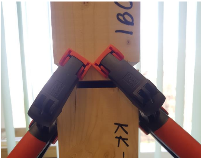
Joonis 6.4. Katsekeha KK-6-09 lõhe tapipesa põhjas.
